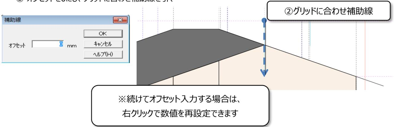
③ グリッドに合わせオフセット350mm(左右2本)、1250mm(左右2本)の補助線を引く
