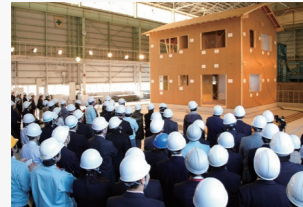
実物大実験を実施し、繰り返しの地震に対する耐震性の高さを証明。
